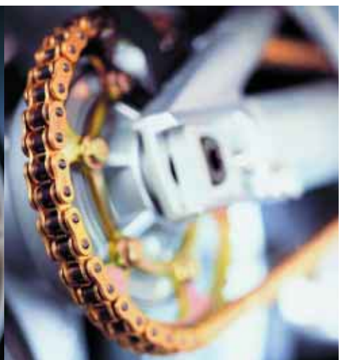
Die Nissan-Doppelscheibenbremse im Vorderrad hatte während des Tests noch nicht die optimale Bremswirkung. Das Hinterrad wird von einer kräftigen O-Ring-Kette angetrieben.
