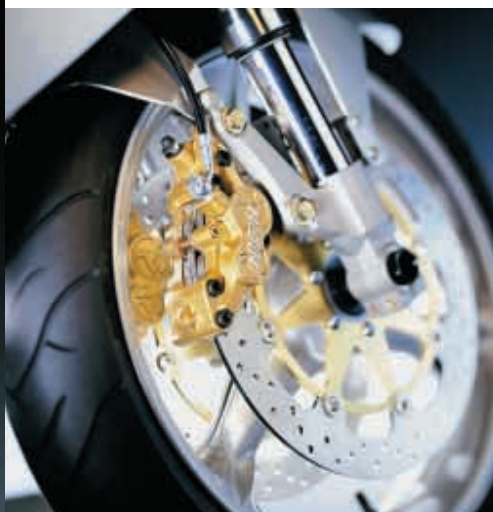
Die Nissan-Doppelscheibenbremse im Vorderrad hatte während des Tests noch nicht die optimale Bremswirkung. Das Hinterrad wird von einer kräftigen O-Ring-Kette angetrieben.
